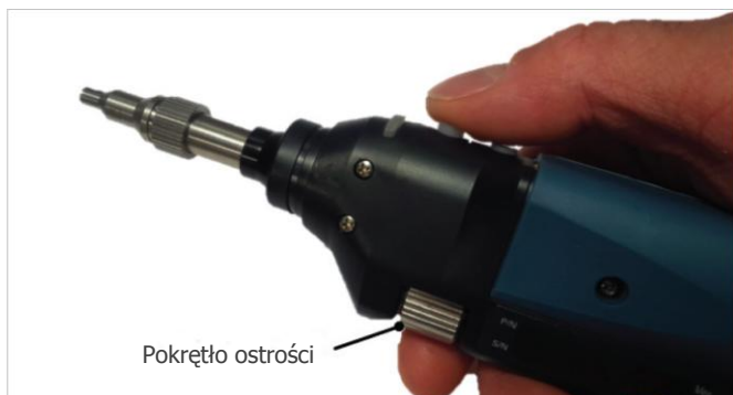
Rysunek 5 .Przykład wieloobrotowego mechanizmu ostrości
